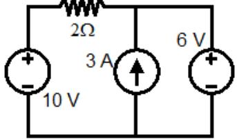
c. Daya yang diserap resistor 2 Ohm
